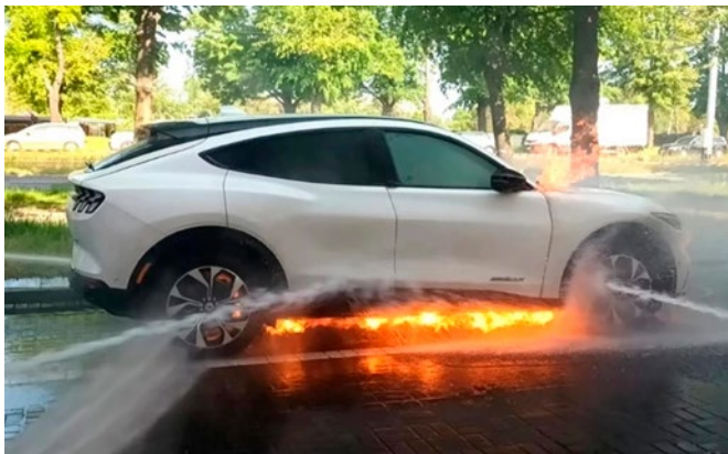
Fot. 1. Pożar samochodu elektrycznego
